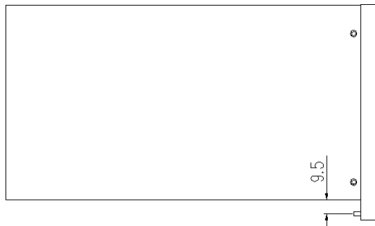
图 3.1.9 模块固定螺钉位置图
